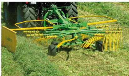
La position des doigts est réglable selon la densité du fourrage
